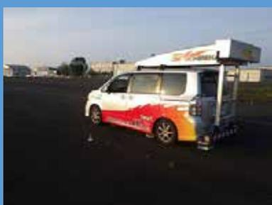
路面性状測定車とICT・IoT・AI技術を組み合わせた調査システム
