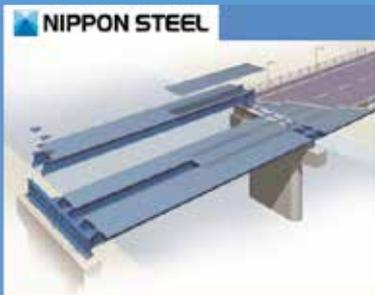
主桁と床版を一体化、部材数の減少による施工の簡易化と
