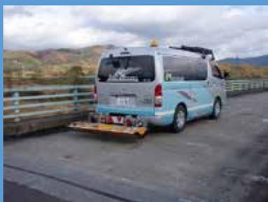
電磁波技術とICT・IoT・AI技術を組み合わせた調査システム
