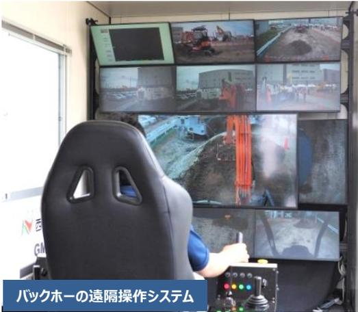
バックホーの遠隔操作システム
