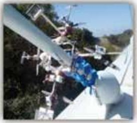
本技術は、点検が容易ではない斜張橋ケーブルの近接目視ができるロボット（VESPINAE）を用いた点検システムを提供するものである。ロボットはプロペラ推力にて昇降する機構であり、高画質ビデオカメラを上下左右に搭載しており、ケーブル表面の全周・全長にわたっての動画を撮影できる。点検者が動画により近接目視でき、高所作業や交通規制を必要とせず安全な点検を可能とした。ロボットは機動性が高く、点検時間の大幅な短縮を実現した。今回はさらに、ロボットが作成した動画からケーブル外観の展開図を作成して損傷箇所を自動検出するシステムの開発を行い、より効率的で高品質の点検成果を提供するものである。
