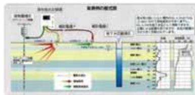
地下水位は液状化の有無の判定や、地中構造物の設計に用いるなど、非常に重要な地盤情報です。接地抵抗を利用した地下水簡易測定法は、土の電気抵抗が地下水位以下で減少することを利用した測定法であり、地中に貫入する金属棒に簡単な装置を設置して接地抵抗を測定することで地下水位位置の判定が可能となります。このため一般的な地質調査で用いられているスウェーデン式サウンディングや簡易動的コーン貫入試験などのサウンディングと併用することで、これまで分からなかった地下水位位置を判定することが可能になります。
