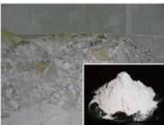
未利用資源のうち、石炭灰や製紙スラッジ灰、廃石膏ボード、製鋼スラグ類の一部にはポゾラン反応による固化・強度発現効果などが期待できるものがあります。また、粒度の悪い循環資材に未利用資源を混合することにより、混合材料や粒度調整を図ることも可能であります。
