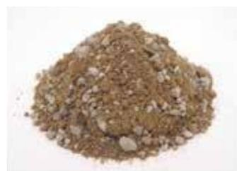
バイオマスボイラーで燃焼した後に発生する焼却灰を、造粒・固化後、山砂と混合し、優れた締固め性能を有した土木資材「エコツブアッシュ®」として製品化しました。復興資材として石巻港湾等の路床盛土、防潮堤に利用されています。
