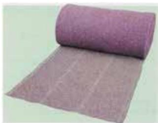
侵食防止特化型植生マット【多機能フィルター】は、さまざまな土質に対応した法面保護資材です。近年多発しているゲリラ豪雨や積雪、凍害からも法面を保護することが出来る侵食防止に特化した植生マットです。施工直後から侵食を防止することにより、土粒子や種子、その他栄養分をその場に滞留（地山の侵食防止）させることで植物生育の精度を高めます。また、冬季施工が可能であることから、工期短縮などの目的にも使用可能です。
