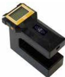
本体とセンサー部を一体化したハンディタイプの水分計です。高周波容量式を採用し、対象物に軽く押し当てるだけで、片手で確実、簡単にすばやく水分が表示されます。従来器「HI-520」に比べ画面サイズは大きくなり、新たにバックライトを搭載しました。また測定対象にコンクリート、モルタル、ALC、人工軽量骨材コンクリート、石膏ボードに加え、新たにケイ酸カルシウム板を追加しました。
