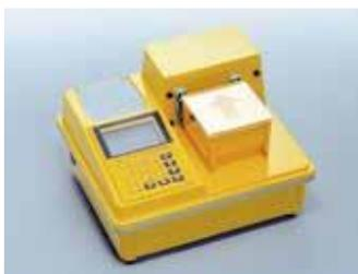
生コン水分計「HI-300」は静電容量を利用した高周波容量式の水分計です。ウェットスクリーニングした生コン(モルタル)を試料容器に入れ、測定キーを押すだけで簡単に水分測定ができ、単位水量と水セメント比を表示することができます。測定データは256点記憶することができ、オプションのプリンターで出力が可能です。
