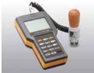
道路橋コンクリート床版の防水施工の際は、床版表面の水分管理が防水層の性能ひいては道路橋の性能を左右する重要な要素となります。これまで床版表面の水分測定の際、表面処理後の凹凸面の影響を受け、測定値が低くなる場合があります。本器HI-100は凹凸面の影響を減らすべく、測定原理に電気抵抗式を採用し、導体ゴム製のゴムセンサを備えました。これにより、凹凸面にゴムセンサが密着し、正確な測定が可能です。なお、本器は(一社)日本建設機械施工協会施工技術総合研究所との共同開発製品です。
