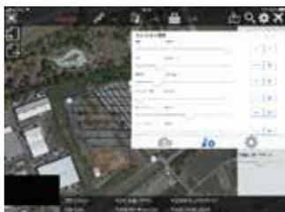
i-Constructionで用いられるドローンを用いた空中写真測量に対応し、熟練者でなくてもi-Con基準に沿ったドローンの自動航行設定が可能なiOSアプリ。アプリとドローンを連動させ、使用するドローンと測量する範囲を決めるだけで高度・オーバーラップ・サイドラップ・撮影パラメータが自動設定され、その場で即自動航行が実行可。また設定内容はクラウドに帳票データとして保存、施工計画書に添付する資料として利用可能。
