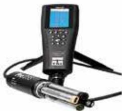
地表水、地下水、沿岸水、水産養殖場の水質検査のために設計されたProDSSは、頑丈で信頼性が高く、最大で17項目の測定に対応します。ProDSSで使用する各センサーは交換可能で、装置に接続すると自動的に認識されます。バックライト付きディスプレイ、大容量メモリ、簡便なキャリブレーション手順、充電式電池、パソコン用ソフト(KorDSS)など使い勝手の良い機能が満載です。そして、オプションのGPS機能、多彩なセンサー、各長さのケーブルがそろい、カスタマイズすることができます。極めて過酷な現場環境でも長期的にサンプリングを継続できる耐久性を実現しています。
