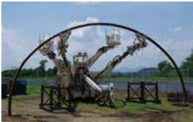
自動追尾型トータルステーションなどで構成する「支保工位置ナビゲーションシステム」、支保工位置の微調整が可能な「高性能エレクターマシン」、ボルトナットの締付を必要としない「自動建込用支保工」により、測量や支保工の位置合わせなど、従来は人が切羽で行っていた作業を機械化し、運転席からの操作のみで高精度な支保工の建て込みを実現します。トンネル切羽直下に人が立ち入ることなく、オペレーター1人で支保工の建て込みが可能となるので生産性と安全性が格段に向上します。本技術は工場による検証を完了し、現在は現場検証段階です。現段階ではナビゲーション技術に留まっていますが、完全自動化に向けて技術開発を推進いたします。
