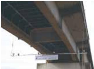
最長12mの両端ヒンジ棒部材(2m以下に分解可能)を高欄部より吊下げ、棒部材に固定した最大6台のカメラを用いて、各カメラのリアルタイム映像を橋上のタブレットから確認しながら、橋軸直角方向の床版下面(総幅員約13m以下)の静止画像を撮影・保存します。そして、装置全体を橋軸方向に所定の間隔で逐次移動させることで、橋梁床版下面全体への点検支援が可能となります。カメラ(高倍率光学式)のズーム・パン・チルト機能操作や撮影は、カメラ毎でも全カメラ同時一括でも可能で、効率的な点検支援が可能です。各カメラは、橋上のLAN用HUBと電力供給可能な有線LAN接続のため、電氣的・通信的な面でのトラブルも少なく、安定した点検作業が長時間でも可能となります。
