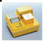
生コン水分計「HI-300」は静電容量を利用した高周波容量式の水分計です。ウェットスクリーニングした生コン(モルタル)を試料容器に入れ、測定キーを押すだけで簡 単に水分測定ができ、単位水量と水セメント比を表示することができます。測定デー タは256点記憶することができ、オプションのプリンターで出力が可能です。
