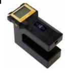
本体とセンサ部を一体化したハンディタイプの高周波容量式の水分計です。対象物に 軽く押し当てるだけで、片手で確実・簡単にすばやく水分が表示されます。従来器「HI-520」に比べ画面サイズは大きくなり、新たにバックライトを搭載しました。また測定対象にコンクリート、モルタル、ALC、人工軽量骨材コンクリート、石膏ボ - ドに加え、新たにケイ酸カルシウム板を新搭載しました。
