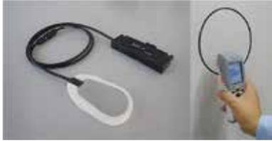
本システムは、鉄筋コンクリート構造物の深刻な劣化を引き起こす、塩害・中性化・化学的侵食などに起因する鉄筋腐食を近傍の腐食環境を評価することで、予防保全を実現できるシステムです。鉄筋を模擬したセンサと構造物表面から電磁波を与える通信部ともに構造物内に埋設するため、表面に露出物は無く、非破壊で、誰にでも簡単に計測可能です。また、無線電波で電源を供給するためセンサには電池を搭載しておらず、計測結果も通信部のメモリに保存する機能により、長期間の維持管理に最適です。新設構造物はもちろんのこと、補修時にセンサを設置することで補修効果の確認にも最適です。
