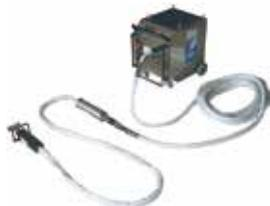
IH（電磁誘導加熱）の原理を被膜除去に応用した工法です。1) IHの原理により、鋼製の素地に対し、専用ヘッドから電磁誘導現象が発生し局所的に鋼板表面を加熱します2)発生した熱により、被膜と鋼板素地間の界面結合が破壊され、剥離が発生します3)浮き上がった被膜はスクレーパーで容易に除去可能です。本工法のメリットは大きく4つあります。①剥離作業の効率化を実現します②粉じん、騒音の発生が殆どなく作業者の安全衛生環境の向上に寄与します③厚膜、剥離困難な被膜ほど有効です④廃棄物は剥離した被膜のみで環境への負荷、運搬・処理コストの低減に寄与します。
