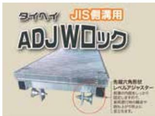
既設の落蓋式U字溝・上蓋式U字側溝を取替えずに戾つると固定式にする場合、既設の側溝に削孔して傷つけることなく、グレーチング固定用枠の4つの広い面を持つアジャスターで突っ張り固定し、グレーチングをボルト固定式に短時間で変更できます。
