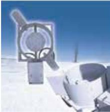
1時間ごとの降雪量を非接触で計測できる高性能の時間降雪量計です。従来の装置よりも小型化を実現、強風雪時や初晩冬期の降雪量を確実に検出でき、短時間降雪で管理される道路・鉄道・空港などで有効に活用できます。
