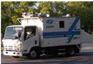
洪水後や地震後に管理延長の長い堤体では、変状や空洞を確認することが容易ではありませんでした。GIMS-Kは、高性能MMSとGPSを活用することで堤防の外観と内部情報を総合的に判定し、空洞を発見するシステムです。
