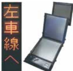
本製品は、高速道路本線常設の情報板と同等の表示能力を持った仮設LED情報板である。軽量(約8kg)かつ薄型の情報板であるため、設置スペースの制約を受けず、通常の仮設LED情報板では設置できないような場所でも、必要な時に設置が可能である。運搬時等は、折りたたむことで、コンパクトに持ち運びが可能である。災害発生時における避難場所案内や交通誘導、あるいは、事故が懸念される箇所での注意喚起等に活用可能である。様々なオプション機器を組み合わせることで、機能の追加が可能であり、例えば、遠隔制御装置やネットワークカメラ等のオプション機器を用いることで、遠隔地からの表示制御、設置箇所の状態確認も可能である。
