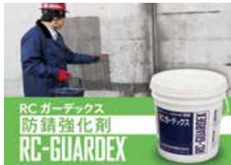
RCガーデックス防錆強化剤は亜硝酸カルシウムを主成分とした塗布型防錆剤である。コンクリート面に塗布し、コンクリート内部の奥深く浸透したRCガーデックス防錆強化剤の亜硝酸イオンにより、鉄筋表面を不動態化し、鉄筋の腐食を抑制する。また、けい酸塩系のRCガーデックスシリーズと併用するとコンクリートひび割れや剥落を抑制する。さらに、カルシウム濃度が通常より高くなるのでけい酸塩系RCガーデックスと反応しコンクリートがより緻密化し、アルカリも付与される。
