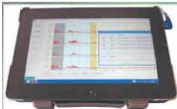
従来、道路附属物(標識・照明施設等)の支柱路面下境界部以下の変状を調査する方法としては、目視又は開削にての確認作業でありましたが、当協会の技術は地中の見えない部分の変状(傷・錆・腐食等)を超音波による診断で判定することにより、非破壊試験による客観的データをもとに二次調査や詳細調査等に活用でき、業務の効率化を計ることやコストダウンにも繋がる技術でございます。1日あたり15本~20本程度(状況・交通量等にもよる)の測定が可能で、難しい解析も必要なく、経済性・安全性にも充分考慮された技術でございます。
