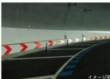
無機塗料と再帰性反射ビーズの複合により車両のライトに反射、ドライバーの視認性を向上させる。カーブなど注意箇所の安全性の向上に最適。無機材を使用しているため安全、紫外線劣化もなく、記号や文字、色も自由にトンネル内壁及び擁壁に直接塗装可。
