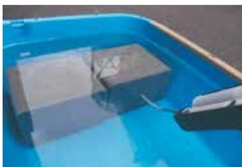
『ボンド E280G』は、水中環境下でのアンカーや差筋定着の施工を可能とする画期的な接着剤です。水中環境下や湿潤面でも硬化し、高強度・高接着力の性能を発揮します。また、2連式のカートリッジシステムを採用しており、先端ノズル内で自動混合されますので計量・混合が不要であり、計量間違いや混合不良などの不具合が出ないため施工管理が容易となり作業の効率化も図れます。毒物・劇物にも該当せず、水道施設の水質試験（厚生省15号）を取得予定です。樹脂の色は水中作業時に視認しやすい赤色となっております。
