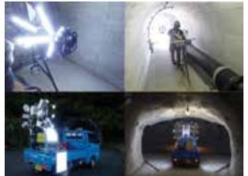
車両などが入ることの出来ない小断面トンネルや水路トンネルなどを高解像度小型カメラで歩行しながら撮影するスクリーニング技術です。撮影は壁面のみならず前方や床面の状況を取得することができますので、坑内全体の撮影を可能としています。また、走行型画像計測同様、近接目視点検と画像スクリーニング技術を併用することで、比較的高精度の変状展開図を作ることができ、尚且つ坑内360°動画を作成することが可能で、ストリートビューのような動画データも実現いたします。
