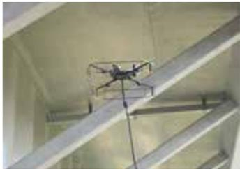
リモコンヘリを用いた構造物点検システムです。橋梁下面など、人の立ち入りや遠方からの視認が困難な個所の点検や調査に活用できます。有線により電源を供給するため、長時間の飛行を可能としました。また、不安定な無線状態を有線により解消しました。搭載するカメラやビデオにより、高画質な動画や写真を取得できます。
