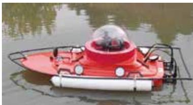
栈橋上部工下面の劣化状況を、ラジコンボートによってリアルタイムに確認できる技術です。ボートの動揺をキャンセルするジンバル（動揺抑制装置）と点検用カメラを搭載し、栈橋下に立ちいらすとも高精細な画像を取得することで点検ができます。
