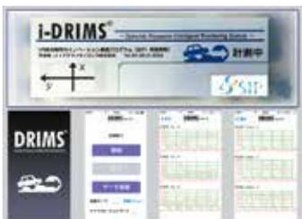
iPhoneまたは車載型センサユニットを用いて、舗装の路面性状をIRI（国際ラフネス指数）で評価するシステムです。特徴として、簡易な取付方法（車内に機器を設置）で車のパネ上でのIRI計測が可能なこと、iPhoneの持つ機能（加速度・角速度センサ、GPS、動画、画像、音声）を活用していることがあげられます。また、本システムは東京大学、京都大学、長崎大学、長岡技術科学大学、当社等が参画するコンソーシアムを通じて、システムの高度化検討・開発及び国内外への展開を図っています。
