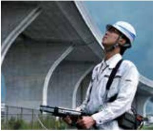
Jシステムは、診断前、診断中、診断後に活用する3つのプロセスを取りまとめ、効率的かつ的確に浮きを抽出するシステムです。このシステムは、(1) 調査前に構造物の熱環境を把握し、調査可能な時間帯を判別する「EM (S) 装置」。(2) モニタで損傷レベルを確認しながら調査ができる「Jモニター」。(3) 熱画像から損傷レベルを3段階に判定する「Jソフト」の3つの技術で構成されています。このシステムにより、危険な浮き箇所をピンポイントで把握できるため、その後の点検・補修作業を無駄なく、効率的に行うことができます。
