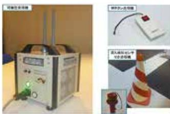
2つの方式で路上規制内の作業現場に緊急事態を遠隔通報できるシステムです。
