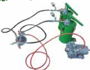
真空吸着機能を有する注入機を用いてひび割れ表面からコンクリート補修材を注入するひび割れ補修工法です。この工法は、注入性能・適応能力・経済効率に優れた画期的なコンクリートひび割れ注入技術です。この技術は、接着養生が不要な注入技術であり、低圧から高圧まで注入圧力を調整できる、補修材（無機・有機）を選ばない、複数の材料を連続して注入できる等の特長があります。さらに、従来技術と比較し優れているのは、ひび割れの深部から表面部までの確に注入することが可能であること、注入機を繰り返し使用するため廃棄物が発生せず、環境負荷が低いことです。
