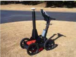
GNSSを使用し、位置情報をリアルタイムで測定しながら地中レーダ探査を行います。これにより50cm未満の測線間隔でも地下情報を取得することが可能となり、探査結果を面的に表現することが出来ます。従来の探査手法では、測線幅の間隔設定により、どうしても探査の間隙や空洞の検出漏れが懸念されておりましたが、広範囲を隙間なくセンチメートル単位で探査データが得られることから、埋設物や空洞の詳細な分布がより鮮明に把握することが出来ます。測定値はすべてデジタル化になり測線図、スライス断面の作成が自動化され、解析業務の効率化が図れます。
