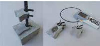
iコンスペーサ®は、ICタグを内蔵したモルタルスペーサです。内蔵するICタグのメモリ、固体識別IDを活用することで、構造物の維持管理に必要な様々な情報を管理したり、外部システムとの連携や管理情報の活用で、構造物のIoTを実現できます。現在、提供可能なアプリケーションは、構造物のかぶり厚を簡易に確認できる「かぶり厚検査システム」と目視点検の結果等を記録・管理できる「点検情報管理システム」の2つがあります。この他、コンクリートの諸情報管理など、様々なシステムへの応用も可能です。使用方法は一般的なモルタルスペーサと同様で、専用治具で鉄筋に固定し、かぶり厚を確保する部品として利用できます。
