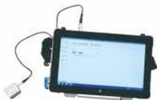
道路付属物の路面境界部における腐食損傷の程度を非破壊で診断できます。
