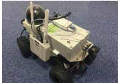
ラジコン式の走行バギーに赤外線カメラ、断面計測用の測域センサー、バギーの位置や姿勢を把握するためのIMU(慣性計測装置)、車軸にエンコーダーを付、排水管のダメージ状況をカメラで確認および埋設経路や断面形状をとらえることで、どのようなメンテナンスが必要かどうかの判断を下すための計測システム及び装置です。排水管の状態を確認するためには、専門の業者による専門の技術者が点検を行うほかありませんでしたが、このシステムは誰もが簡単な操作で安価に排水管の状況を確認することが可能となります。
