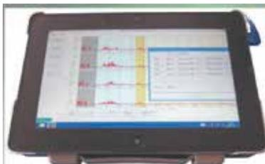
コロージョンドクターとは、道路付属物点検業務における標識柱・照明柱等の路面境界部下40mm部の健全度・腐食度を定期的かつ簡便に診断する超音波測定装置です。SH波振動子および診断ソフトにより、一次スクリーニング調査としてアスファルトやコンクリート基礎を開削することなく診断することが可能となります。難しい解析等の必要はなく、また取扱が簡単なタブレットPCを採用した結果、作業効率や安全性を大幅に向上させることも可能となりました。(埼玉県産品新技術登録済み)
