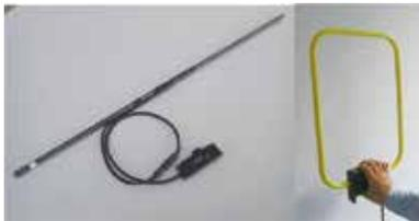
コンクリート構造物は、温度応力や乾燥収縮、鉄筋腐食膨張や外的な荷重や地震などにより様々なひずみが生じます。本システムは、これらコンクリート構造物に生じるひずみを無線で簡単に計測できます。センサ・通信部とも埋設するため構造物表面からの露出物は無く、非破壊で、誰にでも簡単に計測可能です。また、無線電波で電源を供給するためセンサには電池を搭載しておらず、計測結果も通信部のメモリに保存する機能により、長期間の維持管理に最適です。鉄筋に生じるひずみを計測する「標準タイプ」、「高耐久タイプ」のほか、コンクリートに生じるひずみを計測する「コンクリートタイプ」があり、施工管理・維持管理に広く利用できます。
