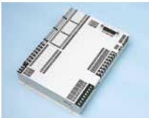
設備監視に必要な機能を集約した多機能データロガーで、ネットワークを構築し、遠隔監視を実現するシステムです。遠隔地の監視ソフトが現地の多機能データロガーと定期的に通信を行い、設備状態を取得し、その結果を元に、現地の多機能データロガーに設備運転・停止の命令を送ります。消雪設備や河川の遠隔監視システム等にも実績があります。消雪設備の遠隔監視では、散水ポンプの状態(運転中、停止中、故障中等)、降雪の状態や気温を監視し、その結果を元に散水ポンプを動作させます。従来は複数の機器やセンサーを組み合わせていたりして遠隔監視システムを構築していましたが、新技術では1台で遠隔監視システムを構築できるようになりました。
