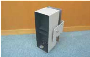
赤外線レーザーを用いて水位を検出する非接触式水位計です。水面をレーザー光で多点走査（スキャン）するため、従来のレーザー距離計と比較して計測エラーを低減しています。さらに異常値を除外し平均化処理を行う事で降雨・降雪・霧などの環境による影響を低く抑える事が出来ます。
