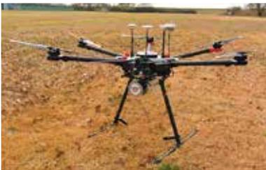
UAVは空の産業革命と言われ、測量分野において従来の航空機による測量や地上測量を補完するための新たなツールとして活用され始めています。特にUAVで取得した画像のSfM (Structure from Motion) ソフトによるモデル化は短時間での概要が把握でき有効といえますが、構造物や地形を含めた細部の再現性に欠けることがあります。そこで精密なデータ取得を目的とし軽量のレーザスキャナをUAVに搭載することで、高精度で迅速な計測を実現しました。特に画像からでは判断が難しい樹木下の地形データの取得が可能で、林業分野で期待されています。もちろん土木分野iConstructionへの活用も可能です。
