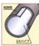
EX工法は、下水道でおなじみの硬質塩化ビニル管(塩ビ管)と同様に工場で製造された管を温めて柔らかくして既設管内に引き込み、膨らましそのまま冷やして形状記憶させる方法で既設管内に新しい塩ビ管の管路を構築する形成工法の熱形成タイプに当たります。これは塩ビ樹脂の、化学反応を伴わないで、温めれば柔らかくなり冷やすと元の固さに戻るという特性を利用したやり方です。工場で製造した際のパイプ品質をそのまま既設管の中で再現できます。
