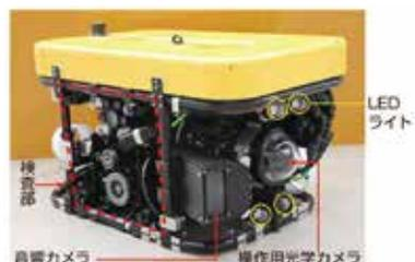
Cetus-Vは、厳しい調査環境にある構造物を安全に点検するために開発された水中調査ロボットです。画像取得の他、調査個所の清掃、鋼材の肉厚計測、コンクリートの打音検査機能を有しています。水深40m以上の大水深域で潜水土による調査が難しい水域で威力を発揮します。
