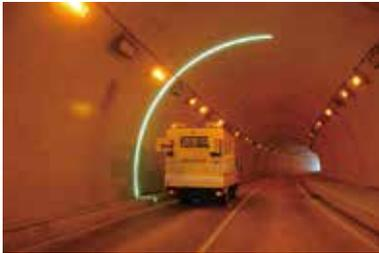
車両総重量が約6tのコンパクトな車両で、路面性状調査とトンネル覆工面調査、道路構造物、付属物調査などが可能です。また、高精度のカラーラインスキャンカメラを搭載しており、時速100kmで走行しながら調査が可能のため、交通規制が不要です。さらに、表面からは見えないライン照明を使用しているため一般車両の走行を妨げません。イーグルにより調査したデータから、路面性状や道路構造物・付属物の現況を記録・認識できるだけでなく、それを元にした様々な評価・解析が可能です。
