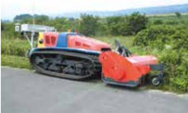
河川堤防の変状は徒歩を基本とした目視点検で行われています。多大な時間と労力を要し、かつ主観的・定性的評価になりがちです。堤防では定期的に除草が行われるため、除草に使用される大型除草機に計測機器を取付け、除草と同時に植生の影響を低減した堤防の客観的・定量的データを計測することで変状を経年的にモニタリングします。本技術は、航空レーザ測深システム(ALB)、水中点検ロボット等の計測技術と複合的に活用され、総合的な河川モニタリングシステムとして提供されます。(本研究は、内閣府総合科学技術・イノベーション会議の「SIPインフラ維持管理・更新・マネジメント技術」(管理法人:国土交通省)によって実施しました。)
