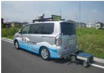
舗装補修を効率的に実施していくには既設舗装の情報が不可欠となります。電磁波技術を活用した非破壊舗装構成・路面性状調査車によって一般車両の流れに沿って調査が行えるので交通規制が不要であり、既設舗装の性状と断面構成、さらに路面に発生したひび割れやパッチング箇所などの路面画像の撮影も行えます。路面性状と舗装構成の変化点が把握できることで適切な維持補修区間と工法の設計や適切な工区分けが行えます。
