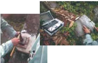
高周波衝撃弾性波法は、衝撃弾性波の高周波成分の伝播特性を利用して、調査対象物内のひび割れ・亀裂の位置や幅、端部の位置等を把握する手法です。土木・建築構造物の基礎杭の長さや内部状態を基礎やフーチングの上面から調査でき、健全性評価も可能です。また、グラウンドアンカーの健全性を頭部コンクリートの上から把握でき、岩塊・転石の形状寸法や岩盤内部の亀裂の状態等の把握にも適用可能です。
