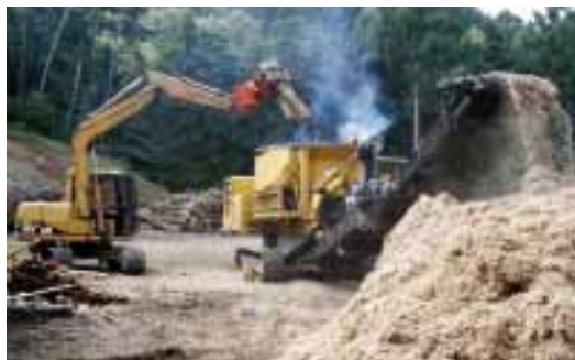
木材破砕機による建設廃材などのウッドチップ化
