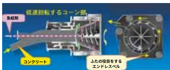
遠心力吹付け機ヘッド部の構造
