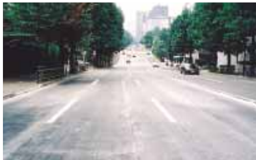
保水・排水性機能を兼ね持たせた保水性舗装
