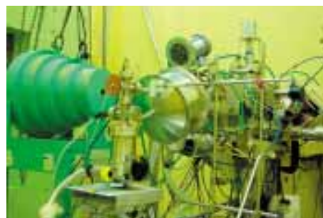
コンクリートの中性子線照射実験 (独立行政法人 日本原子力研究開発機構内の中性子源施設 FNS にて)
