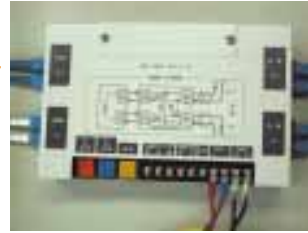
光スイッチ接続・設置状況
